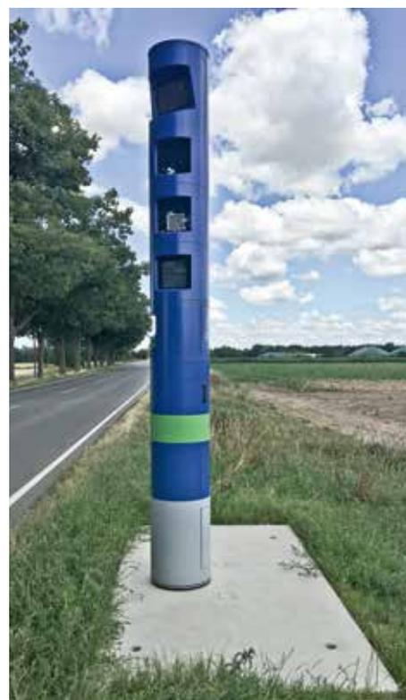
*Säule für die automatische Kontrolle der Mauterhebung*
