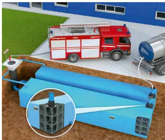
Die Feuerwehr nutzt im Notfall die integrierten Anschluss- und Entnahmemarmaturen
