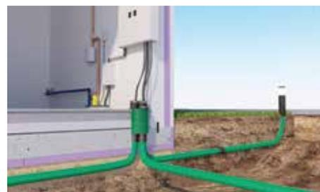
Leerrohre ermöglichen die nachträgliche Belegung mit Versorgungskabeln
