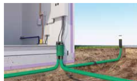
Leerrohre ermöglichen die nachträgliche Belegung mit Versorgungskabeln
