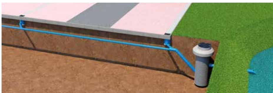
Der Funke Sedimentationsschacht hält einen Großteil der sogenannten abfiltrierbaren Stoffe (AFS) in Niederschlagswasserabflüssen zurück. Er ist für eine Anschlussfläche von bis zu 3.000 m<sup>2</sup> geeignet.
