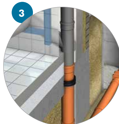
ROHRDURCHFÜHRUNG: BODENPLATTE > HKD® Bauherrenpaket
