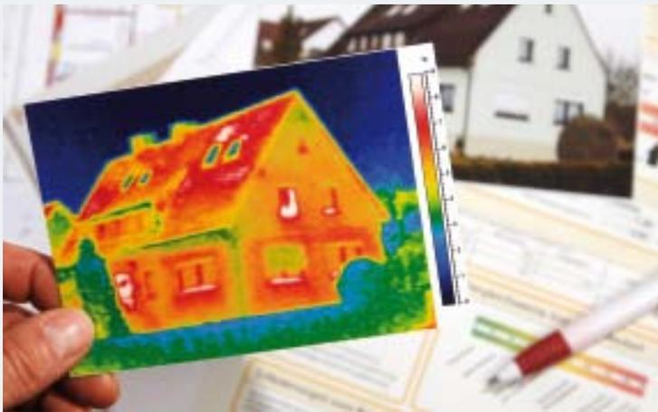
Viele Häuser weisen heute immer noch eine unzureichende Dämmung der Außenwände auf. Die Energieeinsparverordnung erhebt den Wärmeschutz zur Pflicht für alle Hausbesitzer: Durch Außenwände ohne Dämmung geht rund ein Drittel der Wärme verloren. Positiv ausgedrückt heißt das auch: Bis zu 30 % Heizenergie und -kosten lassen sich allein durch eine sinnvolle Außendämmung einsparen. Keine andere einzelne Sanierungsmaßnahme bietet dieses Potenzial!
