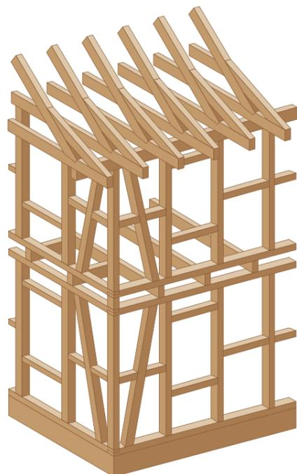
Für den traditionellen Fachwerkbau charakteristisch ist das „zimmermannsmäßige“ Verbinden der einzelnen Kanthölzer des Baugerippes durch Zapfen und Zapfenlöcher. Das entstandene Holzgerippe wurde mit Lehm und Steinen ausgefacht. Das Ausschneiden der Zapfen und Löcher führt zu einer Schwächung des Holzes, sodass das Material stärker dimensioniert werden muss.
