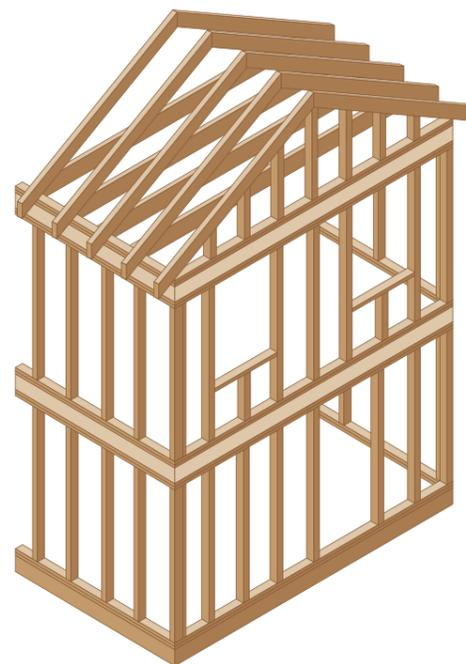
Der moderne Holzrahmenbau ist vergleichsweise ein besonders wirtschaftliches System: Es wird wenig Holz benötigt, standardisierte Holzquerschnitte und ein großes Maß an Vorfertigung ermöglichen eine schnelle, rationelle Bauweise.
