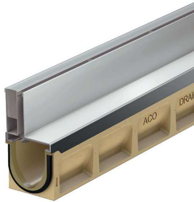
ACO Sideline besteht aus der Entwässerungsrinne ACO DRAIN® Multiline Seal in V 100 S, der Schlitzrahmenabdeckung aus Edelstahl sowie der 29 mm breiten LED-Lichtlinie der Firma Insta GmbH
