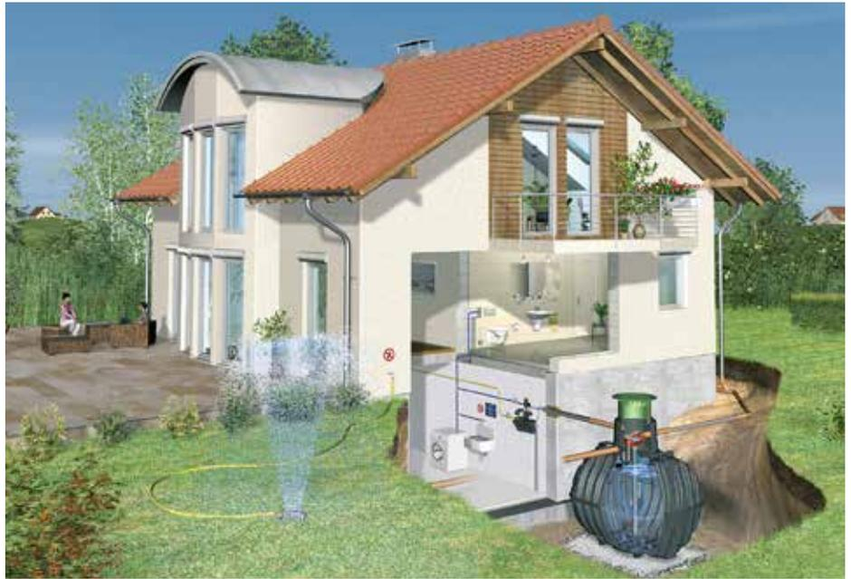
**Das Prinzip: Regenwasser wird vom Dach über die Regenrinnen in den unterirdischen Tank geleitet und von dort über Leitungen per Pumpe entnommen – für die Nutzung in Haus und Garten.**
