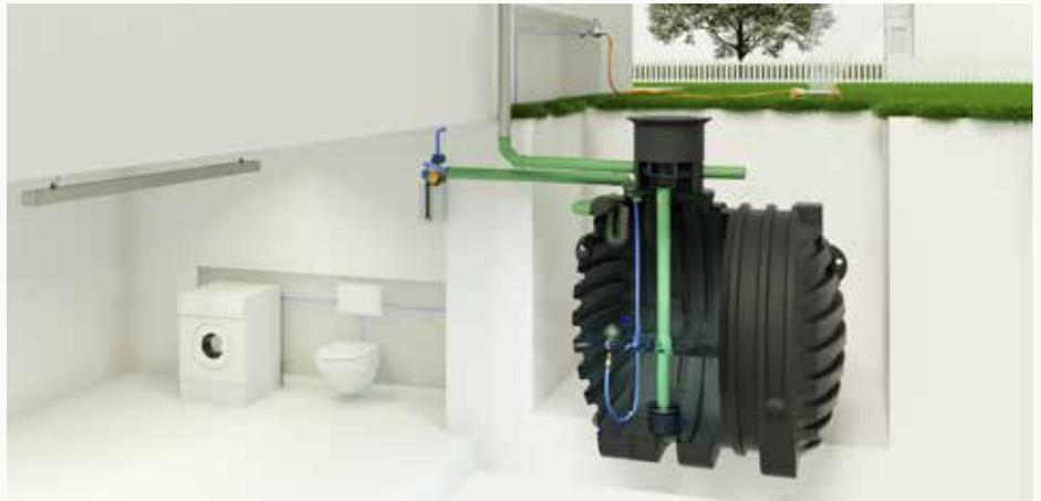
**Vom Wassertank wird das Wasser zur Entnahmestelle im Haus geführt – und von dort zu Einsatzbereichen wie Waschmaschine und Toilette geleitet.**
