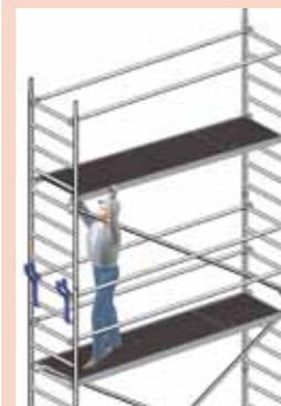
**3** Diagonalen und Durchstiegsbrücke einsetzen.
